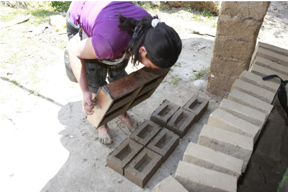
Die Form wird ausgekippt. Die Ziegel müssen noch einige Zeit trocknen.
