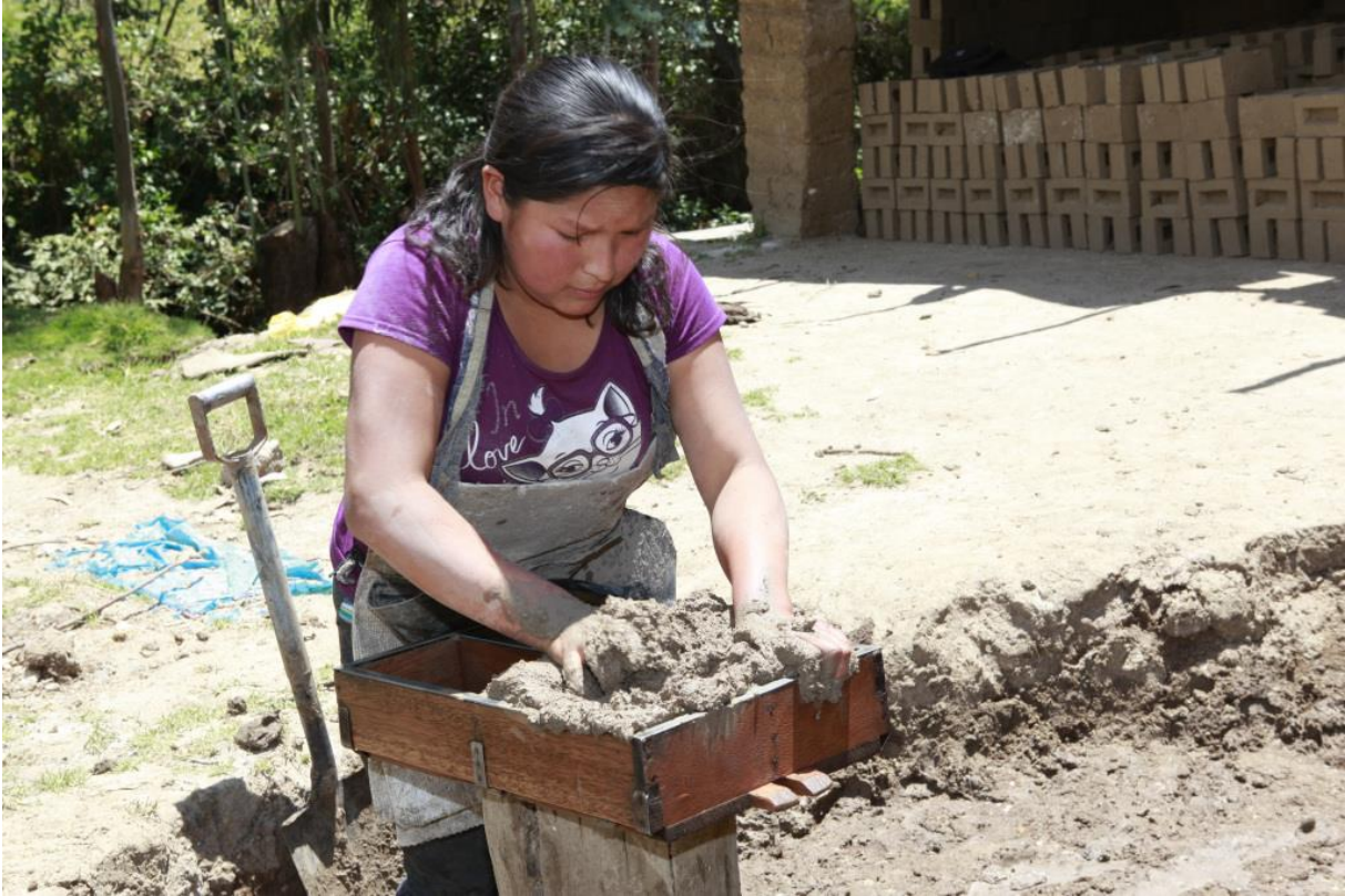
Ziegelherstellung: Der Lehm wird mit den Händen in eine Ziegelform gepresst.
